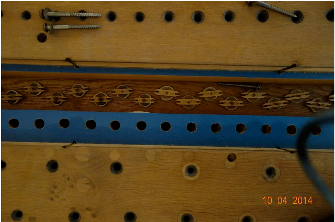
Fotos: Geöffnete Registerkassette mit Sicht auf die Kegelventile
