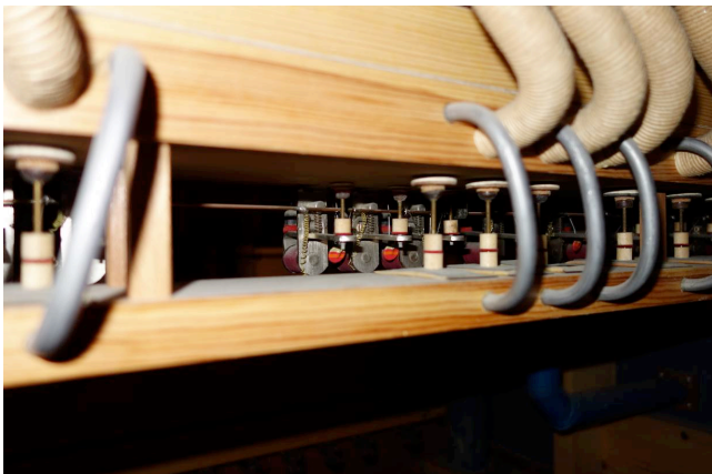
Foto der elektropneumatisch angesteuerten Spiel und Registertraktur
