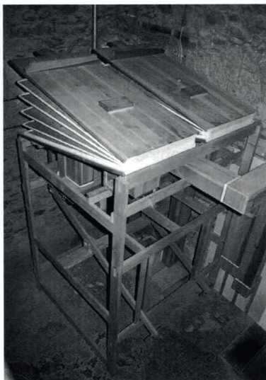
La nouvelle soufflerie installée dans la tour. (Photo François Comment)
