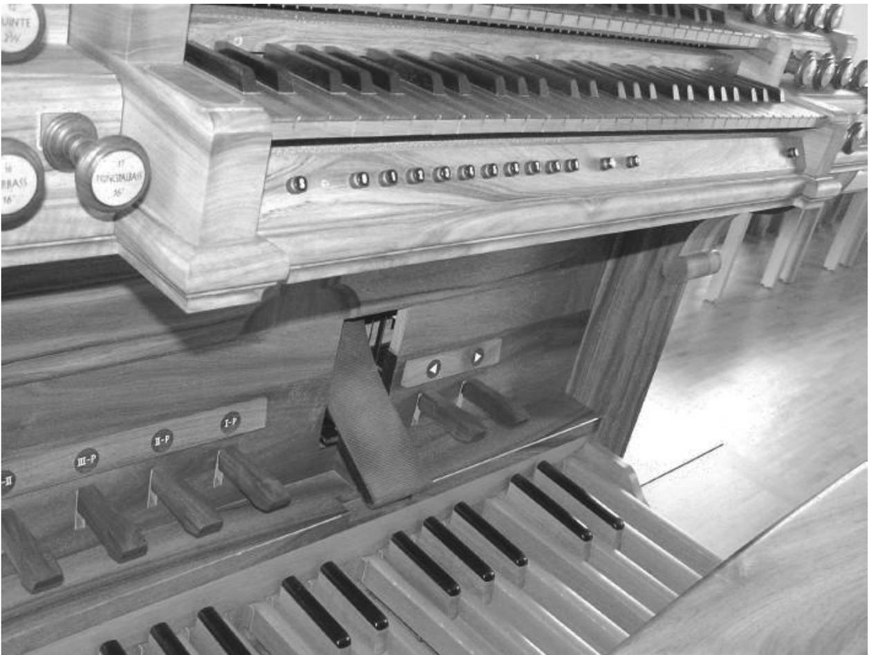
BILD: Unterer Teil des Spieltisches. Unter der Klaviatur links und ganz rechts Knöpfe S und R zur Speicherung der Kombination, dazwischen die Wahlknöpfe (0–9) für die letzte Ziffer der Kombination; in der Mitte die beiden Sequenzertasten vorwärts und rückwärts.
